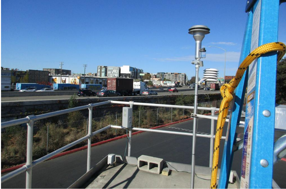
Figura 5-22: Ubicaciones de los sitios de monitoreo del aire cerca de carreteras del Distrito (arriba) y foto de la sonda en el sitio de monitoreo del aire cerca de carreteras Oakland-Laney, junto a la I-880 (abajo). 151
