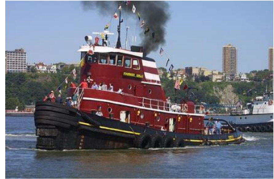
Los remolcadores de funcionamiento marítimo pueden tener motores más antiguos y ser una fuente significativa de materia particulada de diésel
