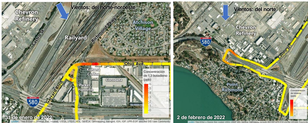
Figura 5. Vista del mapa de concentraciones medidas de a) 1,3-butadieno a lo largo de Ohio Ave. el 31 de enero de 2022 y b) tolueno cerca de la refinería Chevron el 2 de febrero de 2022.
