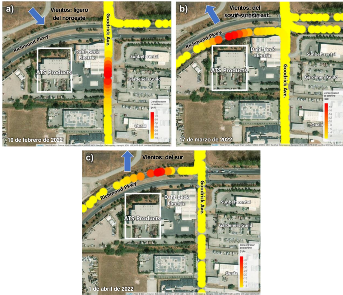
Figura 10. Se midieron niveles relativamente más altos de estireno cerca y en la dirección del viento de ATS Products, una planta de fabricación de plásticos, el a) 10 de febrero de 2022, b) 17 de marzo de 2022 y c) 1.º de abril de 2022.
